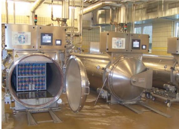
Dampfsprühautoklaven rentieren sich durch massive Einsparungen an Frisch- und Abwasser
